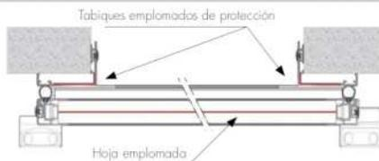
Para una protección reforzada contra los rayos X, se insertan láminas de plomo en la hoja y el armazón de la puerta. Se puede integrar también una ventana anti-X.
