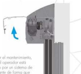
Para facilitar el mantenimiento, el acceso al operador está simplificado por un sistema de capó pivotante de forma que pueda quedar abierto durante el tiempo de la intervención.
